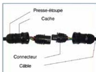
1 - Après avoir dénudé les câbles, les passer dans les presse-étoupes, puis les raccorder sur les bornes à vis.
